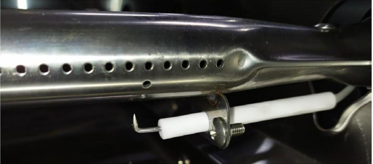
5. Der lose Brenner kann nun vorsichtig in Richtung Vorderseite geschoben werden, bis die Schrauben durch das rückseitige Blech „ausgefädelt“ sind. Bei Bedarf drücken Sie leicht gegen die Rückwand während Sie den Brenner nach vorne ziehen.
