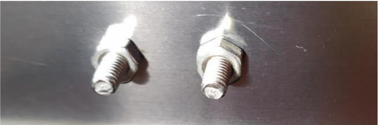
3. Beide Muttern lösen. Damit man diesen Schritt allein bewerkstelligen kann, sind die Schrauben am Brenner angeschweißt. Ansonsten würden sich die Schrauben mit den Muttern mitdrehen.
